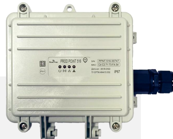
Точки доступа Установленные на стены в ключевых точках шахты
