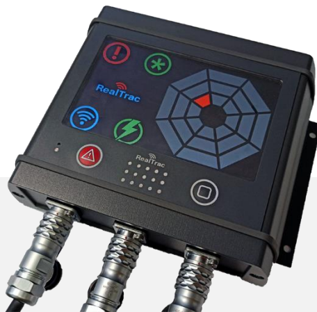
Дисплей оператора Устанавливается в кабине оператора водителя
